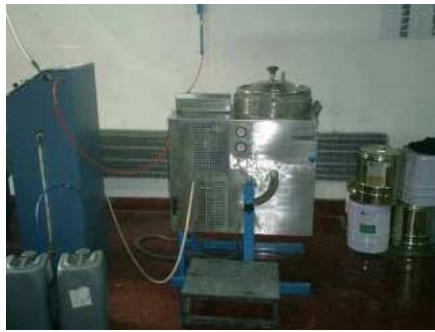
大連YKKジッパー社 加熱減圧方式のリサイクル装置を導入し、洗浄用シンナーを90%回収。 また、廃棄物が固形物となるため、廃棄物の排出量削減にもつながりました。
