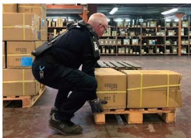
パワースーツ(外骨格ロボット)の試験導入
