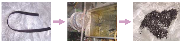
樹脂ファスナーくずを押し機で押し出し、ペレットとして再利用
