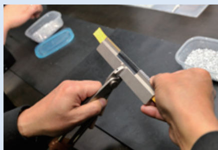
治具にテープを挟み、務歯をへこみにそって同じ方向にはめ込みます
