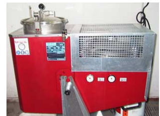
使用済みの溶剤を蒸留分離する装置を導入し、溶剤を回収・再利用( YKKイタリア社 )
