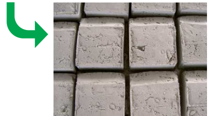
排水処理スラッジにセメントなどを混ぜ、ブロックを製作( YKKインド社 )
