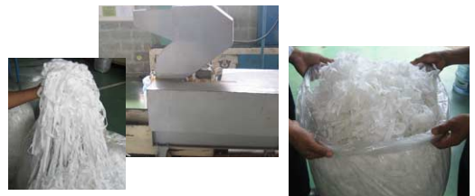
破砕機を導入し、不良テープ屑を枕、人形、マットなどのクッション材としてリサイクル( YKKインドネシア社PPD工場 )
