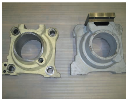
塗料のクロムフリー化 切替前(左)と切替後(右)
