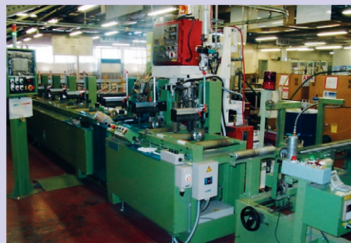
断熱材注入機(非塩素系溶剤を使用)
